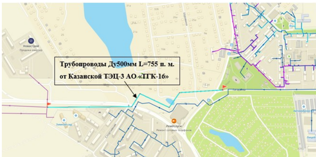
Рисунок 2.1.2 – Трубопроводы Ду500мм L=755 п. м. от Казанской ТЭЦ-3 АО «ТГК-16»
